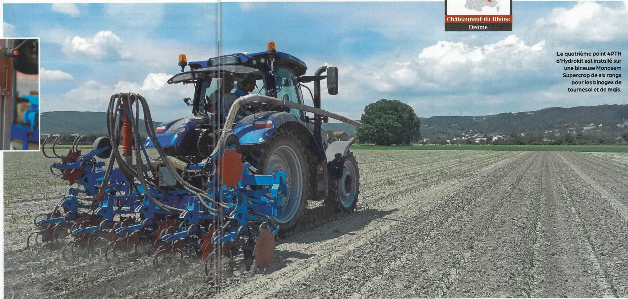
Le quatrième point 4PTH d'Hydrokit est installé sur une bineuse Monosem Supercrop de six rangs pour les binages de tournesol et de maïs.
