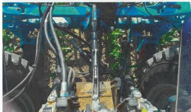
Le quatrième point se fixe sur la trompette du tracteur et, à l'autre extrémité, directement sur le châssis de la bineuse.
