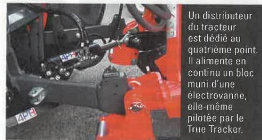
Un distributeur du tracteur est dédié au quatrième point. Il alimente en continu un bloc muni d'une électrovanne, elle-même pilotée par le True Tracker.
