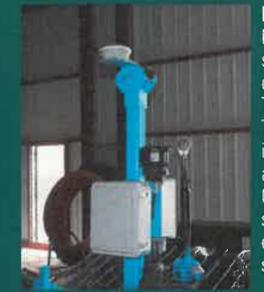
En 2020, Matthieu s'est équipé du système Trimble True Tracker. Il a installé deux antennes GPS, l'une sur le tracteur et l'autre sur l'outil.
