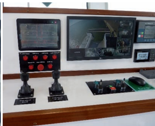
➤ Desde el puente de gobierno del arrastrero es posible operar las maquinillas de pesca, además de controlar y supervisar los equipos hidráulicos mediante pantallas.
