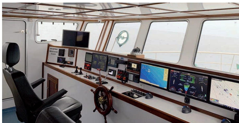
➤ Desde el puente de gobierno del arrastrero es posible operar las maquinillas de pesca, además de controlar y supervisar los equipos hidráulicos mediante pantallas.
