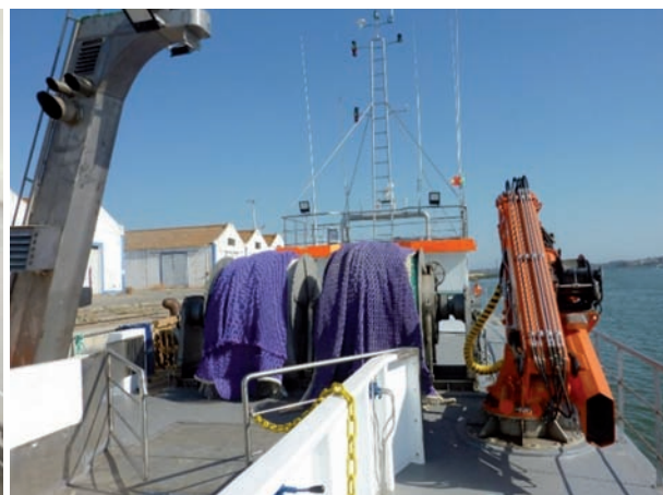
➤ Una de las maquinillas de cable y la de arte y malleta, ambas de acero inoxidable, montadas conjuntamente con la Grúa Guerra.
