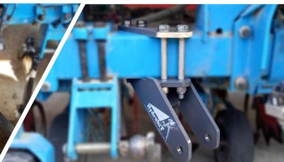
Support prévu pour recevoir le 4PTH ou le stabilisateur d'origine suivant la configuration
