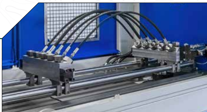
Test et dépollution des flexibles
